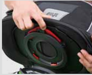
ソフトバッグ底面にある赤いレバーを手前に引いて持ち上げる
